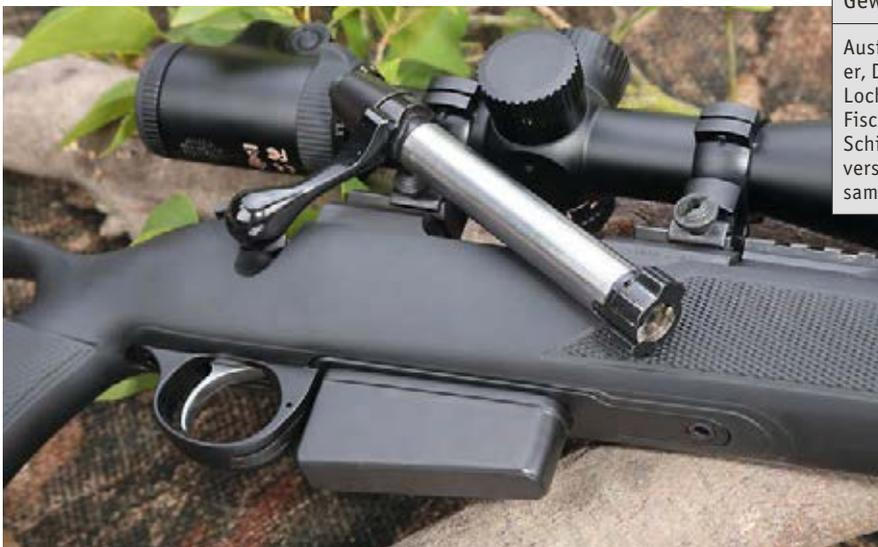
Ausführung: Zwei-Warzen-Zylinderverschluss-Repetierer, Direktabzug, Zwei-Stellungs-Sicherung, Synthetik-Lochschaft mit Pistolengriff, Gummikappe und Fischhaut an den Kontaktflächen, Picatinny-Scout-Schiene, offene Visierung mit höhen- und seitenverstellbarer Kimme und seitlich driftbarem Lichtsammelkorn, Mündungsbremse mit 1/2-20 UNF-Gewinde.
