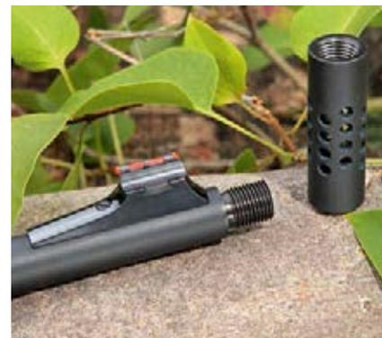
Das rote Lichtsammler-Korn ruht samt Träger in einem Schwalbenschwanz im Sattel. Die Büchse kommt serienmäßig mit einer Mündungsbremse, sie kann bei Bedarf einem Schalldämpfer weichen.
