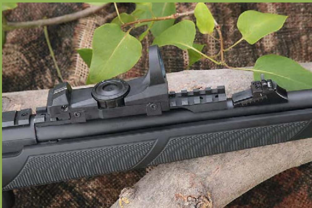
Ihrem Namen entsprechend stattet Frankonia die Mercury 870 Compact Scout mit einer Scout-Schiene zur Aufnahme von Rotpunkt-Visieren aus. Die Schiene mit dem Picatinny-Profil reicht von der Laufwurzel fast bis zum Kimmensockel.
