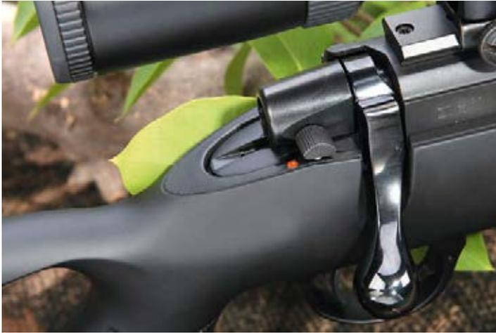
Die Zwei-Stellungs-Sicherung sitzt rechts vom Schösschen, hier in Feuer-Position. Das Schloss ist entspannt, sonst würde der Schlagbolzenkopf hinten deutlich sichtbar aus dem Schösschen ragen.
