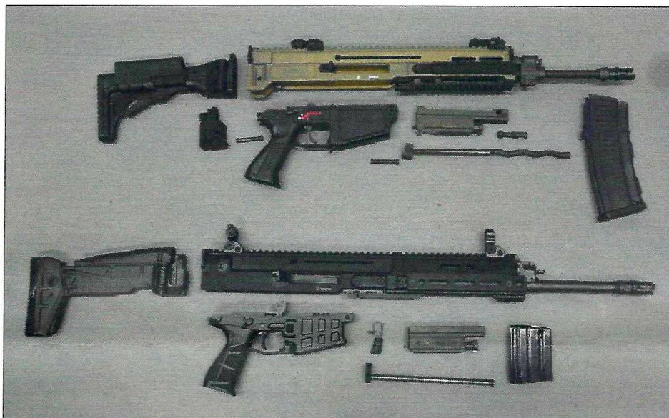
Abbildung 5: Vergleichsansicht rechte Seite, oben die vollautomatische „CZ 805 Bren“, unten „CZ Bren 2Ms“, beide zerlegt in die jeweiligen Hauptgruppen
