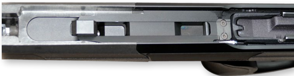
Durch die schräg angesetzte Schraube am Vorderschaft (o.) werden die beiden Nasen des Austauschlaufs (Mitte) in die Aussparungen im Systemkasten (u.) gezogen. Prismenförmige Anlageflächen links und rechts garantieren unverrückbaren Sitz.
