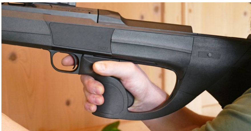
Knapp 2 kg Druck sind für die Handballenspannung nötig und müssen gehalten werden. Die abgesetzte Form der Kammer ermöglicht den Repetierweg unter die Schaftbacke.
