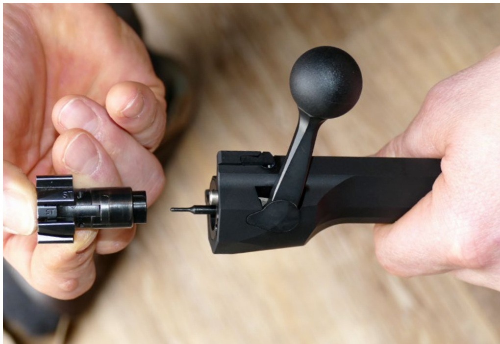
Der Verschlusskopf ist entnehmbar. Dazu muss nur der Auszieher nach außen gedrückt werden. Gut sichtbar ist dann der herausragende Schlagbolzen.
