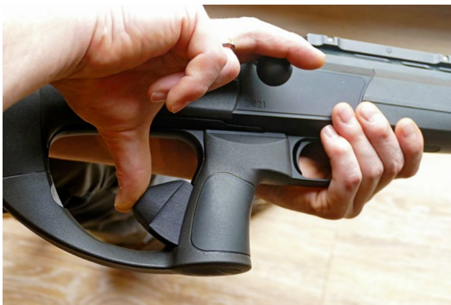
Mit einer Hand möglich: Während der Daumen etwas Druck auf die Handballenspannung gibt, zieht der Zeigefinger den Kammerstängel nach hinten.
