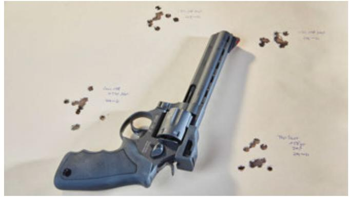
Manche Laborierungen zeigen nach dem Einschwenken der Trommel Absetzer. Viele Streukreise liegen am und unter dem Durchmesser der Zehn. Das „Ding“ auf der Kimme ist ein Schutz, kein Red Dot.
