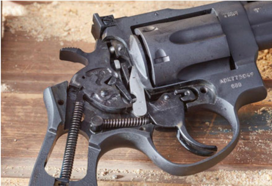
**Das Schloss arbeitet über Schraubenfedern. Abzugs-Rückstellfedern mit geringerer Energie (Reduktion des Abzugswiderstandes) werden zur Zeit nicht angeboten.**
