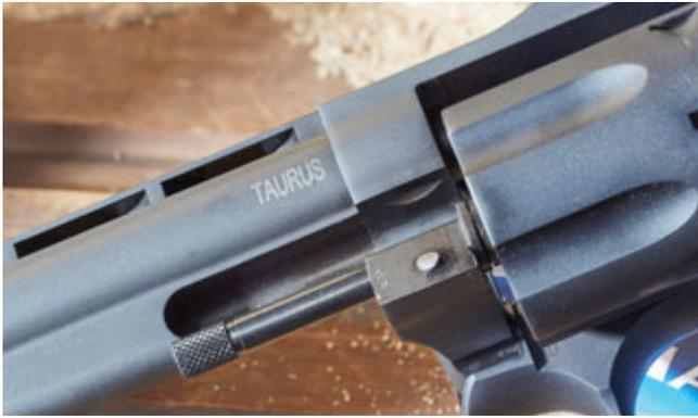
Die Verriegelung des Trommel-Kranes erfolgt über einen angeschrägten Druckstift und dessen Eingriff über die Kante einer etwa halbmondförmigen Ausfräsung im Rahmen.
