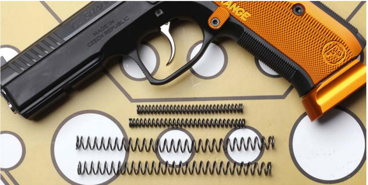
Im Lieferumfang der Shadow 2 Orange sind auch unterschiedliche Schlag- sowie Verschlussfedern zum Wechseln enthalten.
