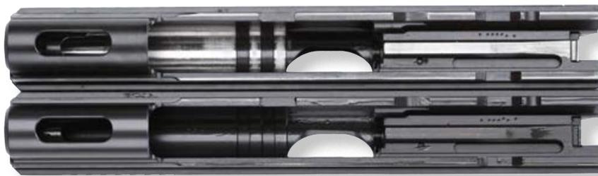
Auch die Verschlüsse ähneln sich bis auf die Mündungspartie sehr stark. Der Verschluss der Orange wurde im Inneren aber partiell poliert.
