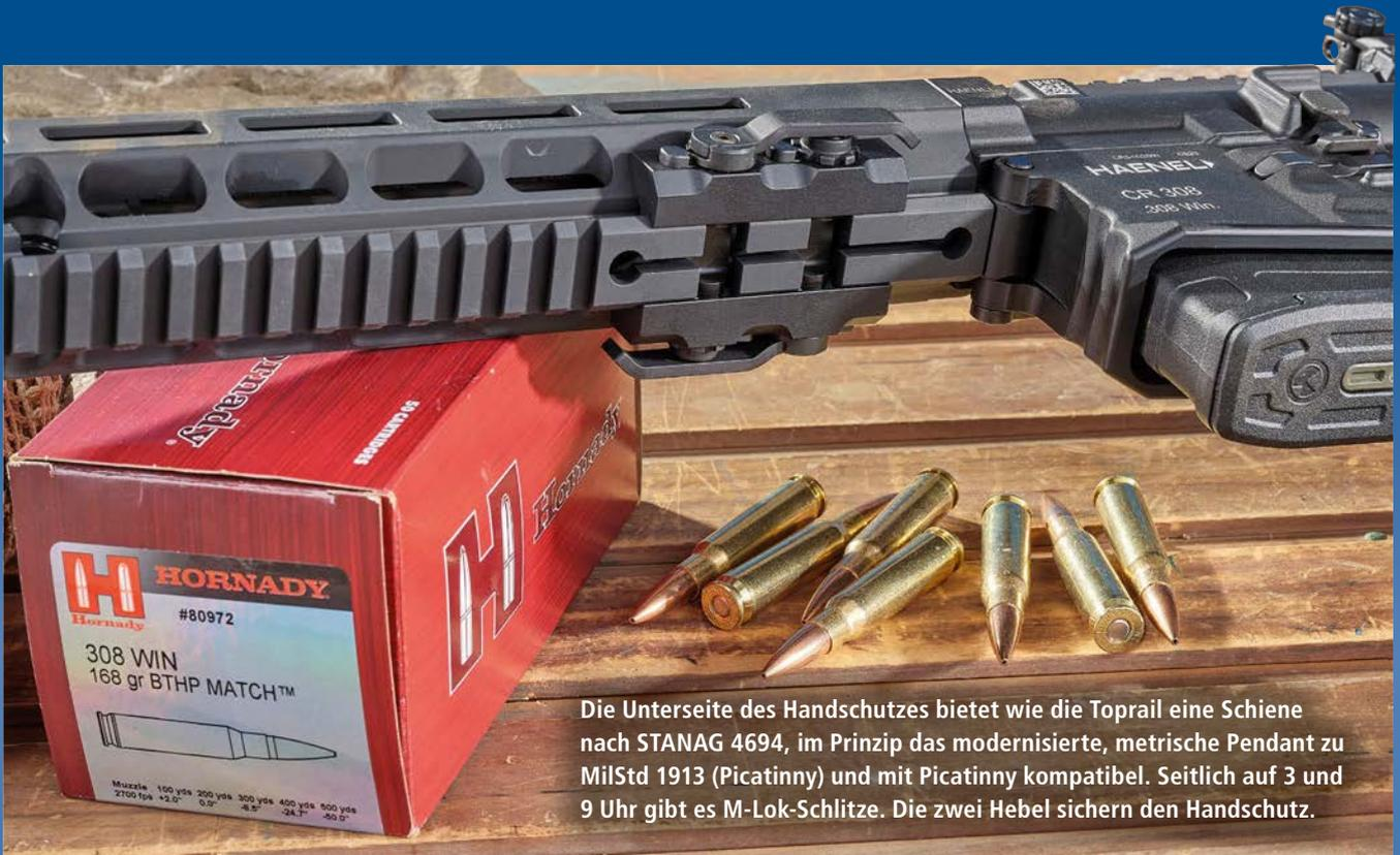
Die Unterseite des Handschutzes bietet wie die Toprail eine Schiene nach STANAG 4694, im Prinzip das modernisierte, metrische Pendant zu MilStd 1913 (Picatinny) und mit Picatinny kompatibel. Seitlich auf 3 und 9 Uhr gibt es M-Lok-Schlitze. Die zwei Hebel sichern den Handschutz.
