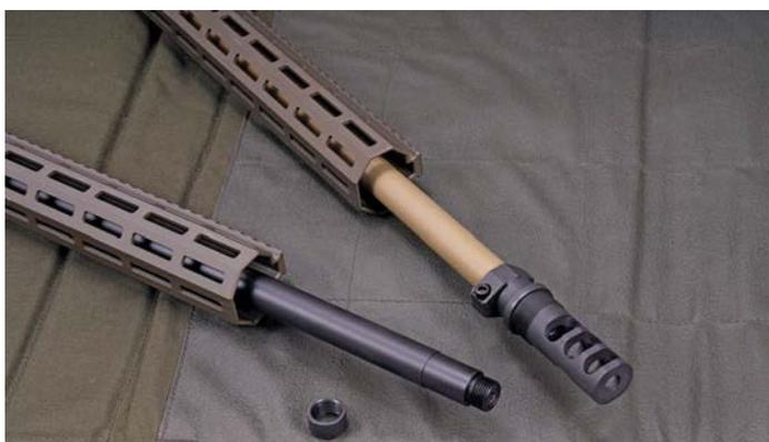
Blick auf die Mündungen mit M18x1,5-Gewinde und Abdeckkappe (Basic) sowie aufgeschraubter und geklemmter Mündungsbremse mit Schalldämpfer-Schnittstelle (Pro).
