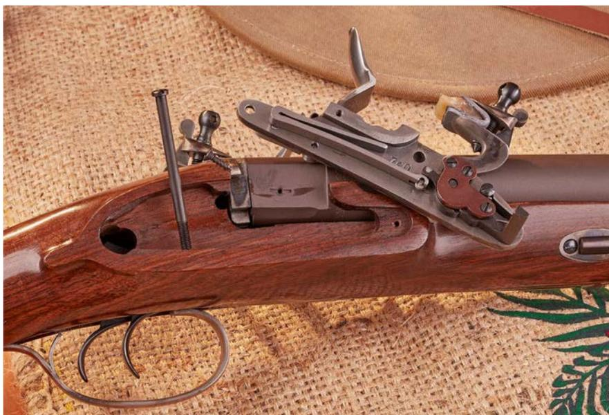
**Schlossbesichtigung:** Nach Lösen zweier Schrauben kann man die Schlossplatte aus dem Schaft der Pedersoli Howdah entnehmen.
