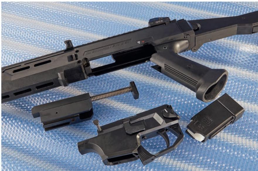
Die untere Gehäusehälfte mit Abzugseinheit lässt sich über einen Bolzen fix abnehmen. Dadurch gelangt man an die Verschlussgruppe samt Schließfeder.
