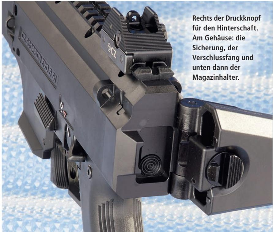
Rechts der Druckknopf für den Hinterschaft. Am Gehäuse: die Sicherung, der Verschlussfang und unten dann der Magazinhalter.
