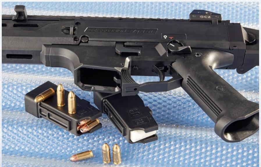
Durch den angetricherten Magazinschacht geht das Nachladen schnell von der Hand. Größere Magazinrichter aus Leichtmetall gibt's für die Scorpion Evo als Tuning-Teil.
