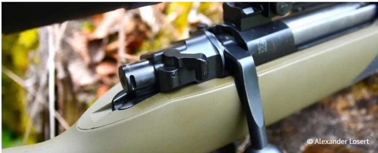
Klassiker: Beim Öffnen des Verschlusses spannt sich das System, was am Schlösschen zu erkennen ist.
