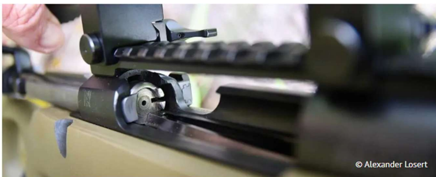
Der „Soldatenstop“ sorgt dafür, dass der Verschluss bei leerem Magazin nicht mehr nach vorne bewegt werden kann.
