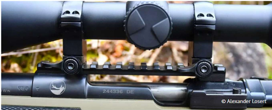
Die Picatinny-Schiene gehört zur Ausstattung der Forest Favorit S22, macht das Laden von oben schwer, zumal die Waffe ein fest verbautes Magazin hat.
