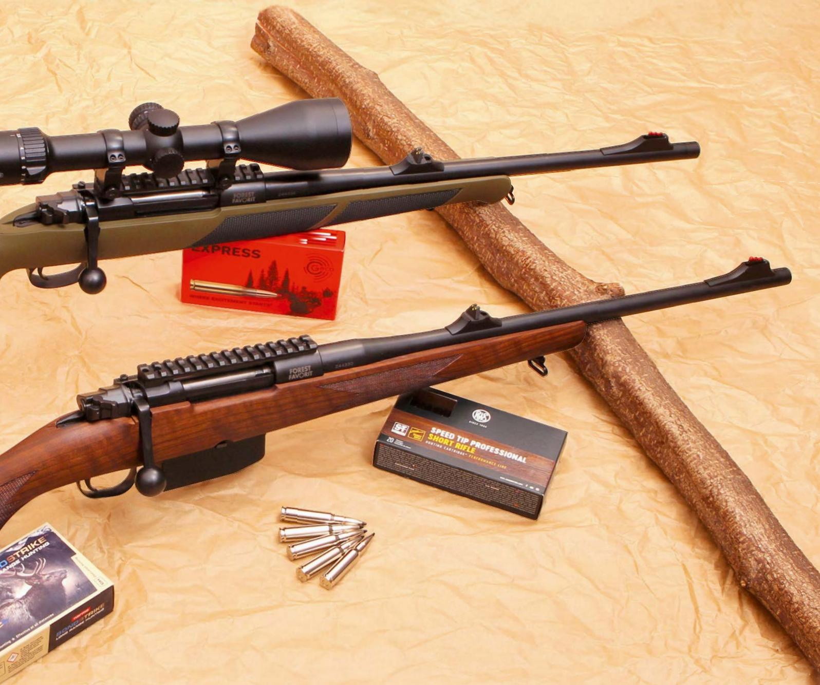
Die konstruktiven Vorzüge von Mausers Konstruktion bleiben vollständig erhalten: Die Kammern verriegeln über je zwei Warzen im Hülsenkopf, dazu dient eine dritte Warze im hinteren Bereich als Sicherheitselement. Der Öffnungswinkel liegt bei 90 Grad. Erhalten bleibt ebenfalls der charakteristische lange Auszieher. Dieser sorgt in Verbindung mit der Magazinzuführung für das berühmte „Controlled Feed“, auf Deutsch: die kontrollierte Zuführung. Dabei wird
