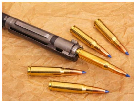
That's Mauser-Style: Blick auf den Verschlusskopf – der Auszieher hält die Patrone und ermöglicht so deren kontrollierte Zufuhr.
