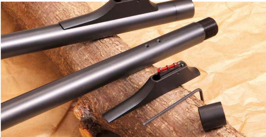
... dazu je ein i-Sight-Korn mit Leuchtstab, hier einmal montiert und einmal demontiert, man sieht die zwei Haltebohrungen zum Kornsattel-Versetzen.
