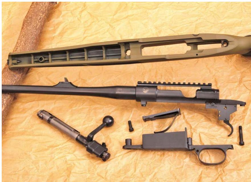
S22 Synthetik zerlegt: Schaft, Baugruppe Lauf/ Systemhülse / Abzug/Rail, Verschluss, Baugruppe Abzugsbügel/Magazinschacht mit Halteschrauben-Duo.
