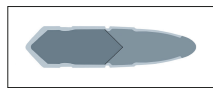
RWS Uni Classic: Ein Geschoss mit nickelplattiertem Stahlmantel mit Scharfrand und Torpedheck (hinten härterer Bleikern als vorne). Ein Klassiker, der zuverlässig deformiert
