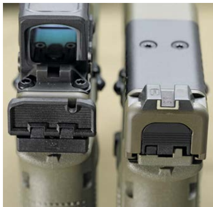
Die Glock G45 A-CUT COA Hunter Edition erhielt am Verschlussheck eine Durchladehilfe, die mit ihren moderat überstehenden Flügeln jedwede Waffenmanipulationen verbessert.
