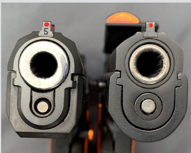
Rechts eine TS Orange der ersten Generation mit dünnem Lauf und halbrundem Dust Cover. Links eine TS2 Orange der zweiten Generation mit eckigem Dust Cover und weitaus massiveren Laufwandstärken. Beide Modelle sind heute noch im Programm vertreten
